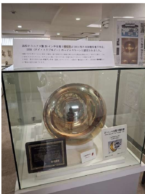
ニュートリノを観測するためにカミオカンデに使われている 20 インチの光電子倍增管
