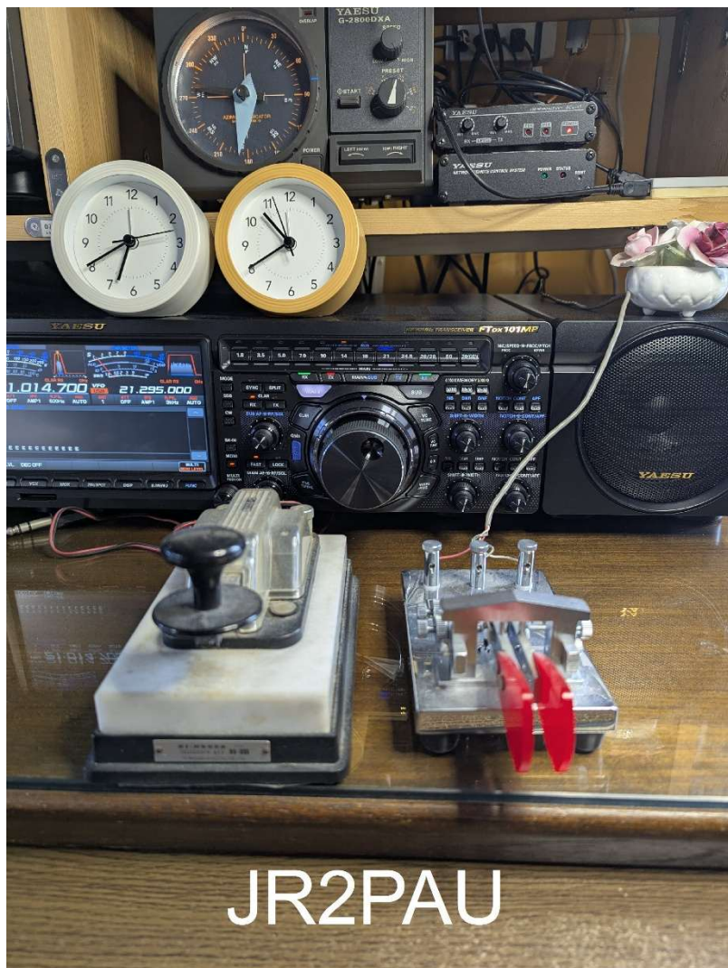
試験に使った縦振り電鍵と 現在のキーヤー
